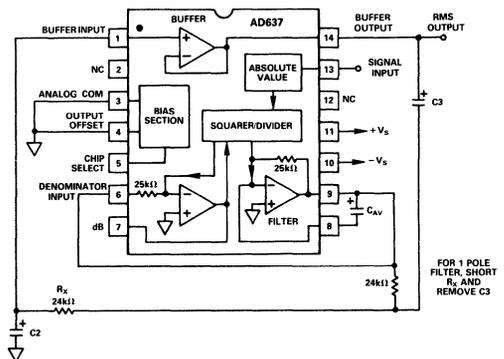
Figure 8. Two Poje Sallen-Key Filter
