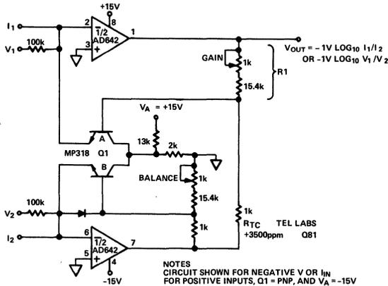
Figure 28. Log-Ratio Amplifier
