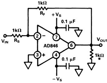
\*PLUS 2pF SCOPE PROBE CAPACITANCE
