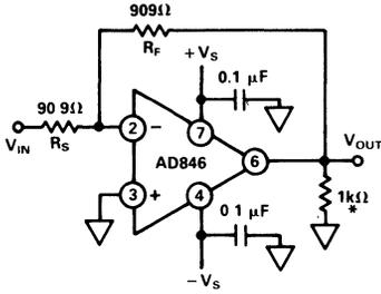
\*PLUS 2pF SCOPE PROBE CAPACITANCE
