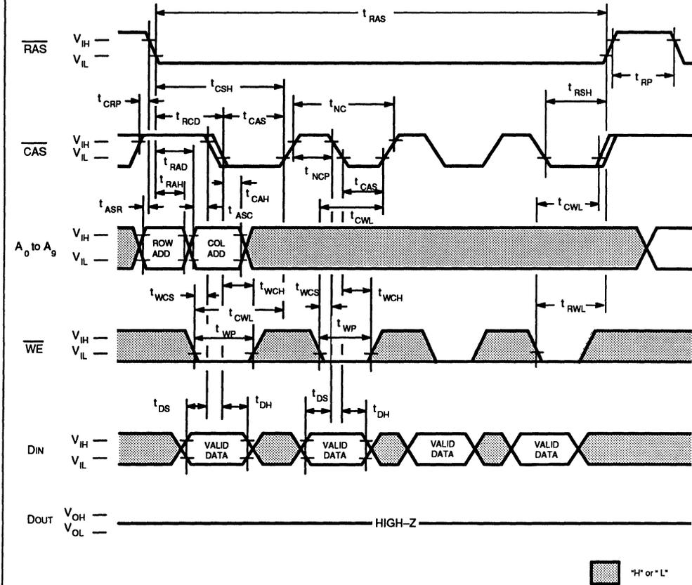
Fig. 10 -  $\overline{\text{RAS}}$ -ONLY REFRESH CYCLE
