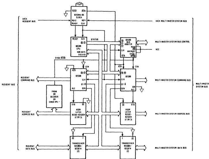
FIGURE 6. 82C89 BUS ARBITER SHOWN IN SYSTEM - RESIDENT BUS CONFIGURATION
