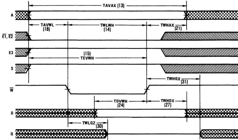
**WRITE CYCLE 2:  $\overline{E1}$ ,  $\overline{E2}$ , or  $E3$  CONTROLLED (NOTE 2)**
