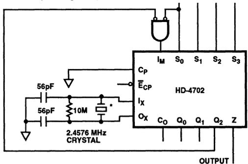
**FIGURE 3. 19200 BAUD OPERATION**
