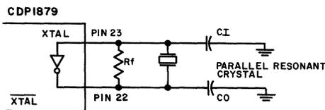
FIGURE 31. SUGGESTED OSCILLATOR CIRCUIT FOR 1, 2, OR 4-MHz OPERATION
