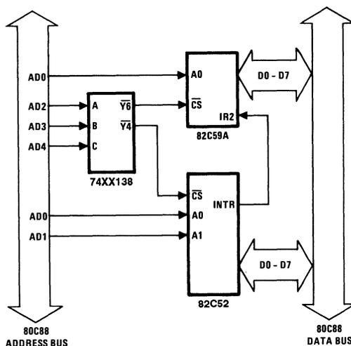
FIGURE 15. INTERRUPT DRIVEN SYSTEM
