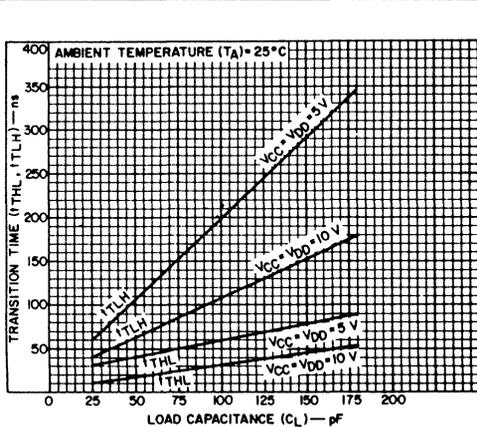
FIGURE 4. TYPICAL TRANSITION TIME VS. LOAD CAPACITANCE
