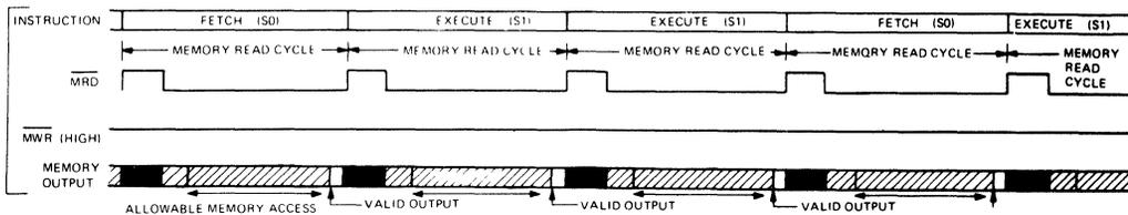
**NO. 4 LONG BRANCH OR LONG SKIP CYCLE TIMING WAVEFORMS**
