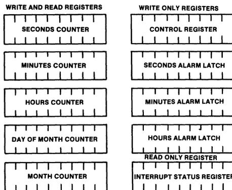
**FIGURE 12. PROGRAMMER'S MODEL OF THE REGISTERS OF THE CLOCK**
