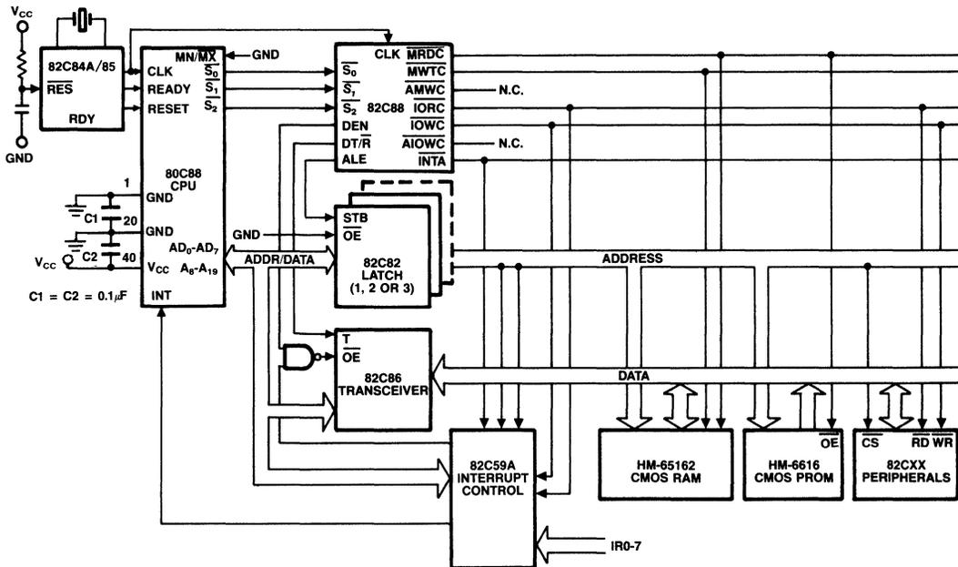
FIGURE 4. FULLY BUFFERED SYSTEM USING BUS CONTROLLER
