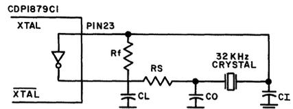
FIGURE 30. SUGGESTED OSCILLATOR CIRCUIT FOR 32KHz CRYSTAL OPERATION
