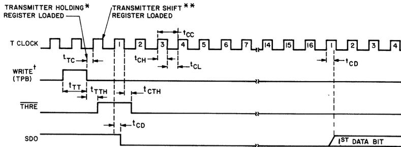
\* THE HOLDING REGISTER IS LOADED ON THE TRAILING EDGE OF TPB
