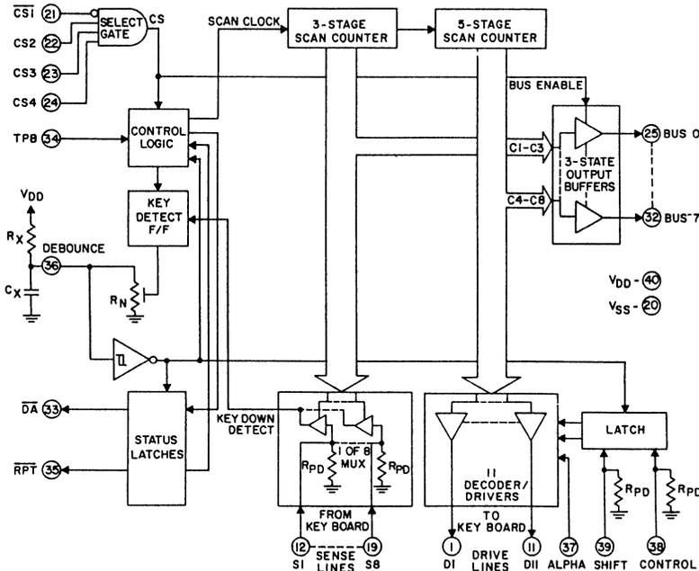
FIGURE 1. BLOCK DIAGRAM OF THE CDP1871A KEYBOARD ENCODER
