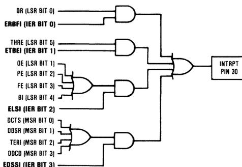
FIGURE 1. 82C50A INTERRUPT CONTROL STRUCTURE
