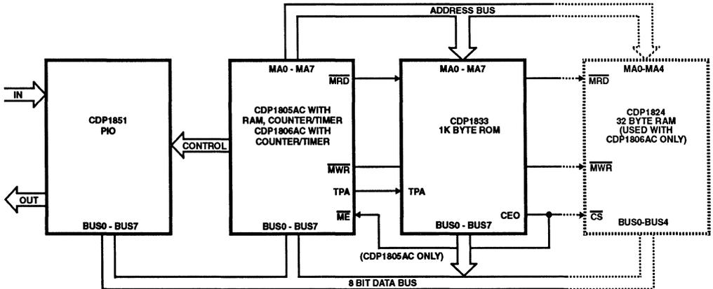
FIGURE 1. TYPICAL CDP1805AC, CDP1806AC SMALL MICROPROCESSOR SYSTEM
