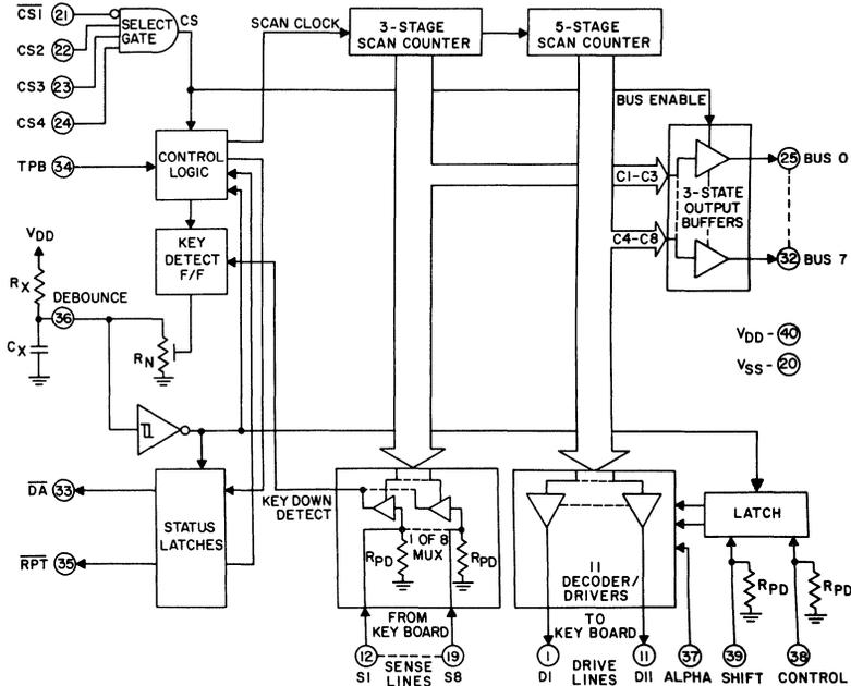
FIGURE 2. CDP1871A BLOCK DIAGRAM
