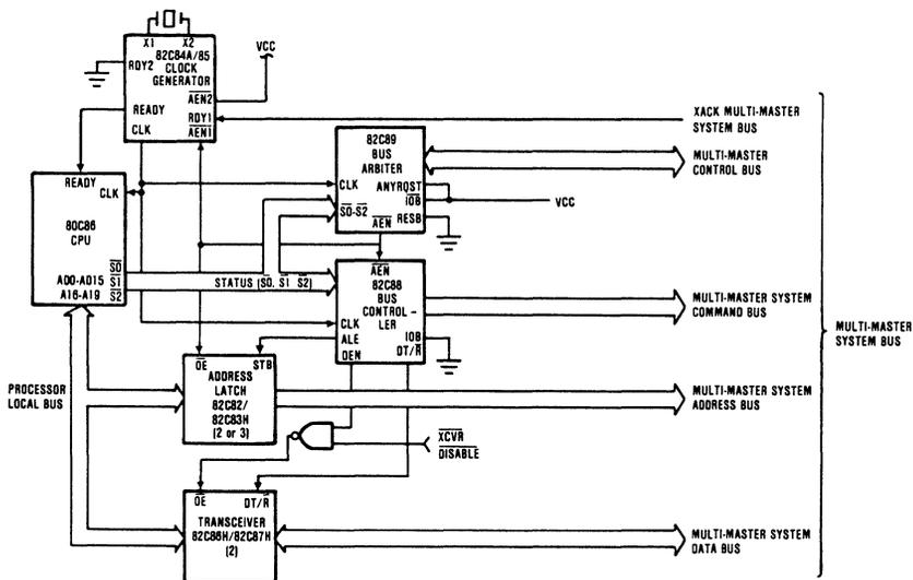
FIGURE 4. TYPICAL MEDIUM COMPLEXITY CPU SYSTEM
