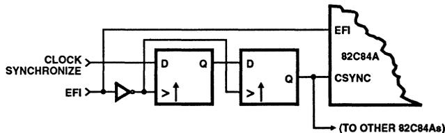
FIGURE 1. CSYNC SYNCHRONIZATION
