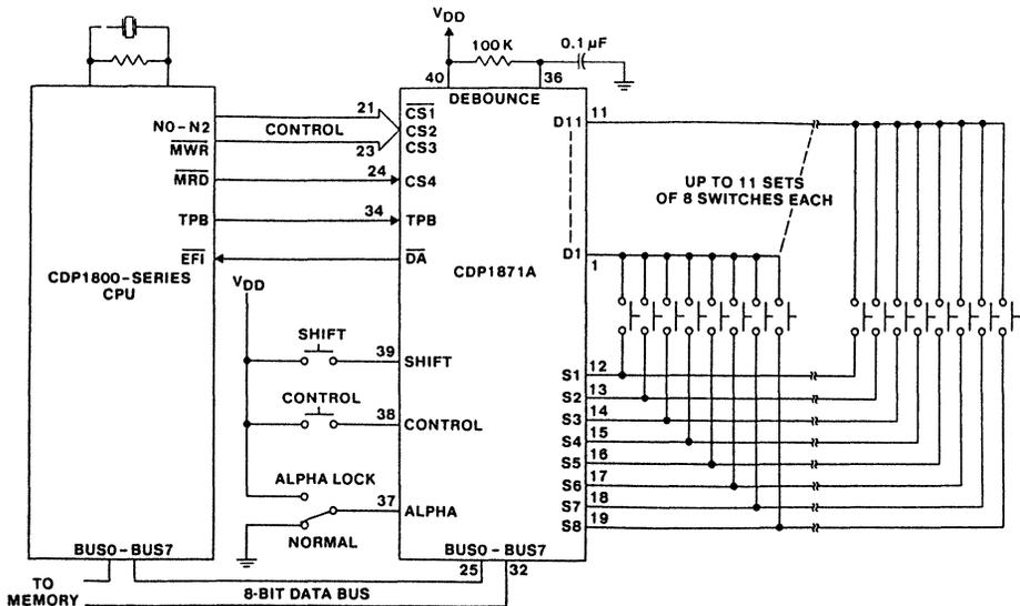
FIGURE 4. TYPICAL CDP1800-SERIES MICROPROCESSOR SYSTEM USING THE CDP1871A
