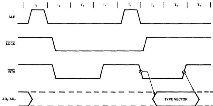
FIGURE 7. INTERRUPT ACKNOWLEDGE SEQUENCE
