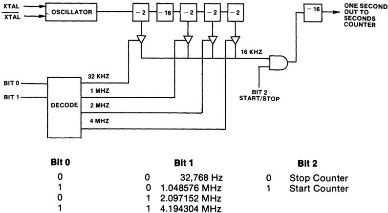
**FIGURE 18. FREQUENCY-SELECT OPERATION**
