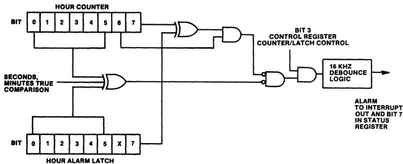
**FIGURE 24. ALARM LOGIC**
