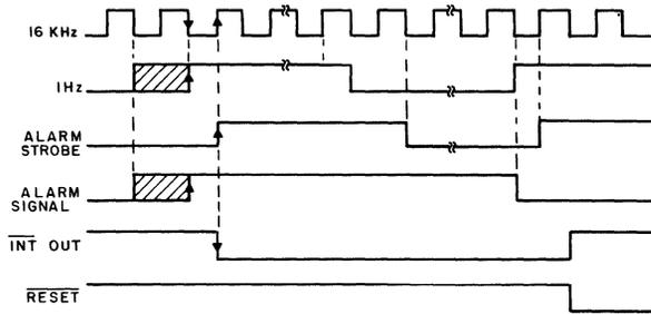
FIGURE 23. DEBOUNCE WAVEFORMS
