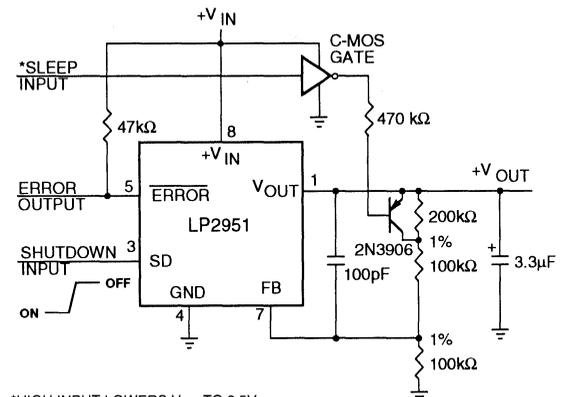
\*HIGH INPUT LOWERS  $V_{OUT}$  TO 2.5V
