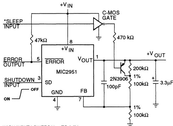
\*HIGH INPUT LOWERS  $V_{OUT}$  TO 2.5V
