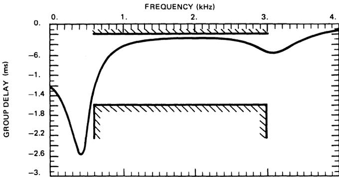
**Rx BAND-PASS AND REJECTION FILTER TYPICAL GROUP DELAY TIME AND LIMITS CHART**
