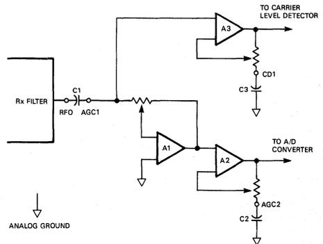
FIGURE 3. Rx AMPLIFIERS SCHEMATIC
