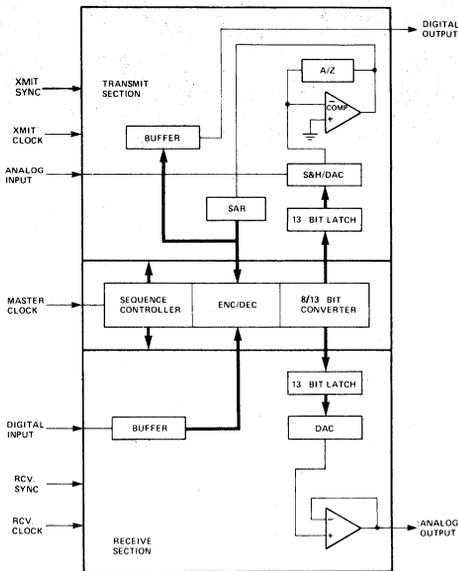
Figure 3. MK5156 Block Diagram
