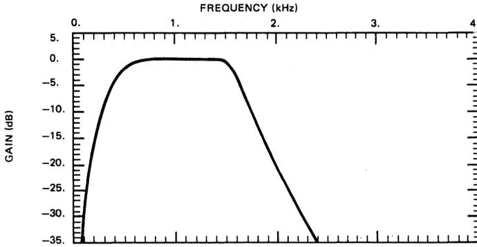
Rx BAND-PASS FILTER TYPICAL RESPONSE FOR V.22 MODE (LOW CHANNEL)
