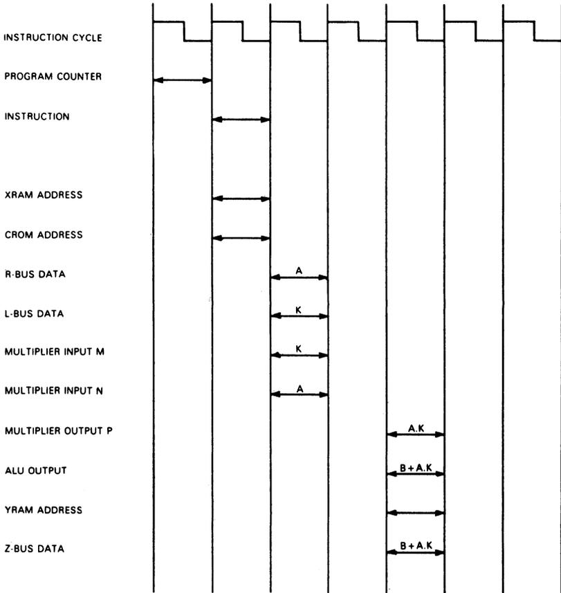
FIGURE 4.1.A. - PIPELINE DELAY
