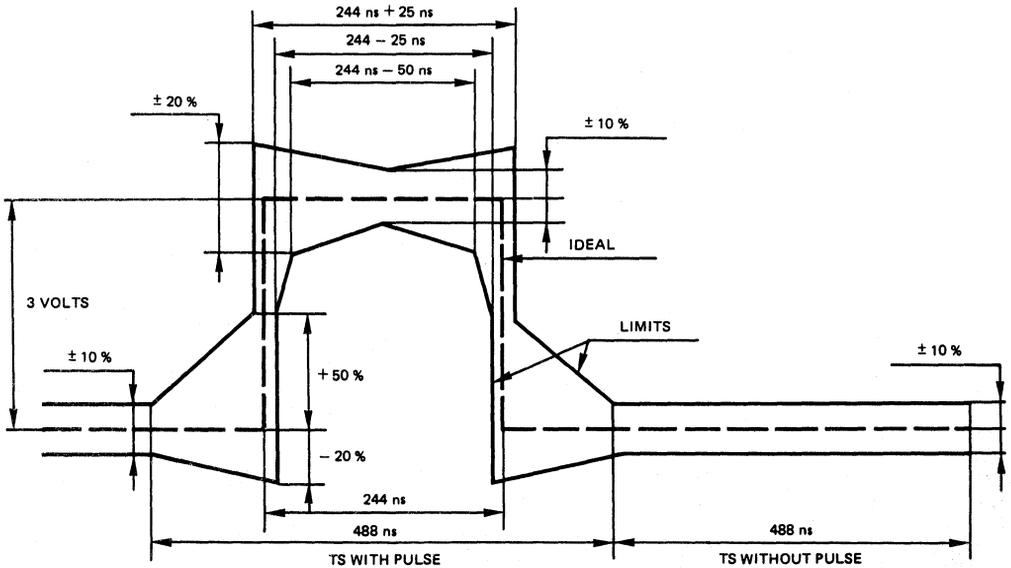
FIGURE 6 -- PULSE SHAPE FOR 2048 BIT/S CEPT PCM JUNCTION
