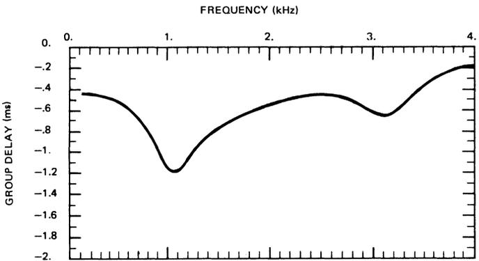
**Rx BAND-PASS FILTER TYPICAL GROUP DELAY TIME FOR V.22 MODE (HIGH CHANNEL)**
