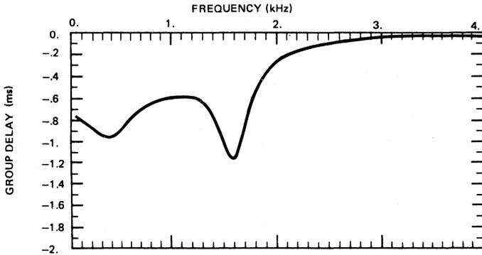
Rx BAND-PASS FILTER TYPICAL GROUP DELAY TIME FOR V.22 MODE (LOW CHANNEL)
