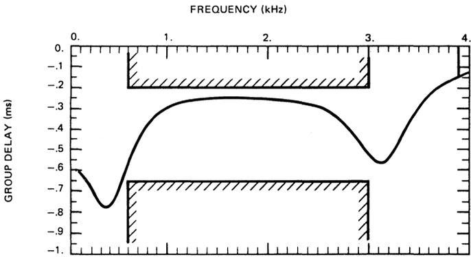
**Rx BAND-PASS FILTER TYPICAL GROUP DELAY TIME AND LIMITS CHART**
