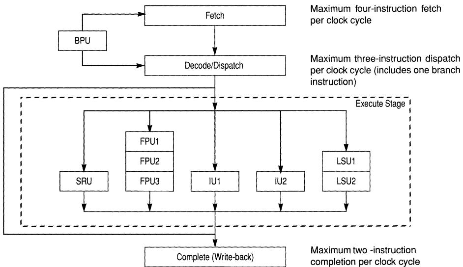
**Figure 6-2. Superscalar/Pipeline Diagram**
