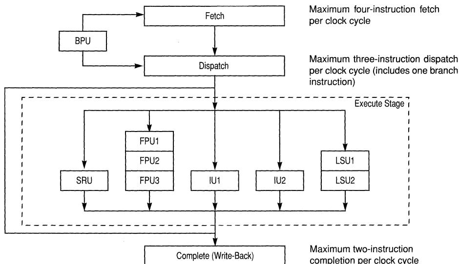
**Figure 1-6. Pipeline Diagram**
