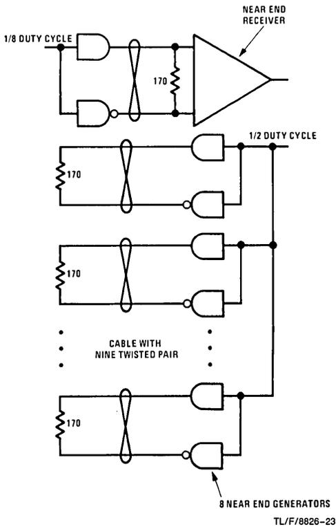
FIGURE 25. Signal Cross Talk Experiment Using DS7830, DS7820A
