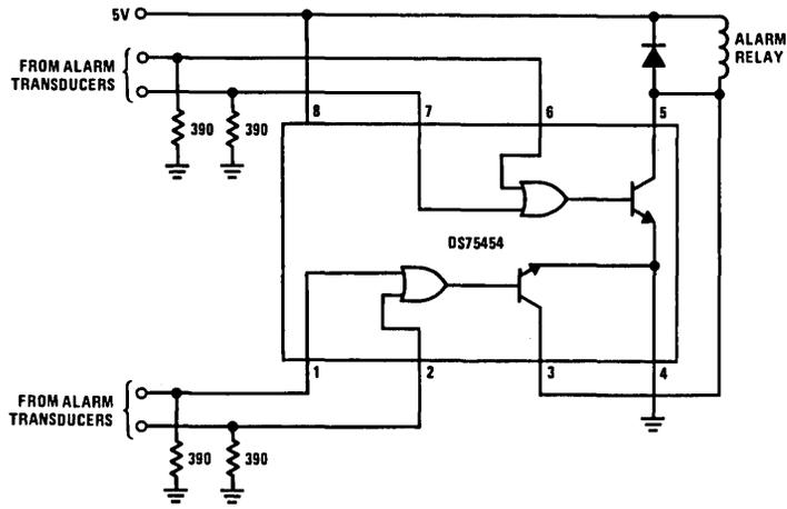
**FIGURE 35. Alarm Detector**
