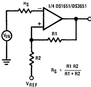
$$R_S \approx \frac{R_1 R_2}{R_1 + R_2}$$
