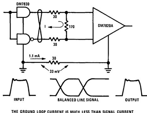
THE GROUND LOOP CURRENT IS MUCH LESS THAN SIGNAL CURRENT
