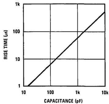
FIGURE 11. DS3691 Rise Time vs External Capacitor
