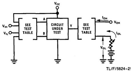
**FIGURE 7.  $V_{IH}$ ,  $V_{IL}$ ,  $I_{OH}$ ,  $V_{OL}$**
