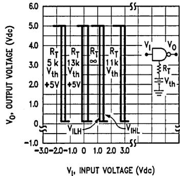
FIGURE 2. DS1489 Input Threshold Voltage Adjustment
