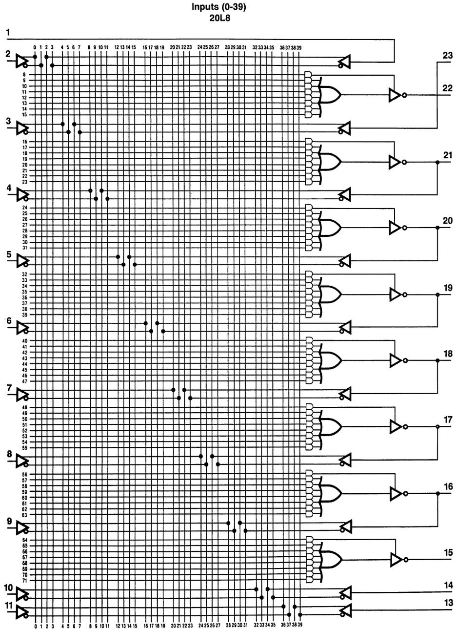
Figure 4.4.24 Logic Diagram PAL20L8
