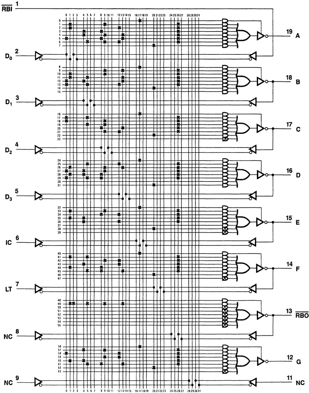
Figure 8.4.2 Logic Diagram PAL16L8
