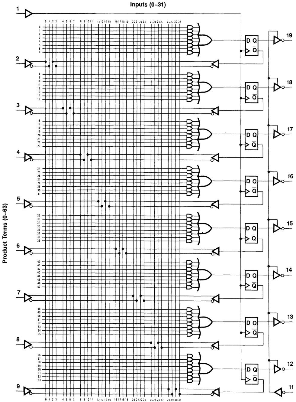
Figure 4.4.11 Logic Diagram PAL16R8
