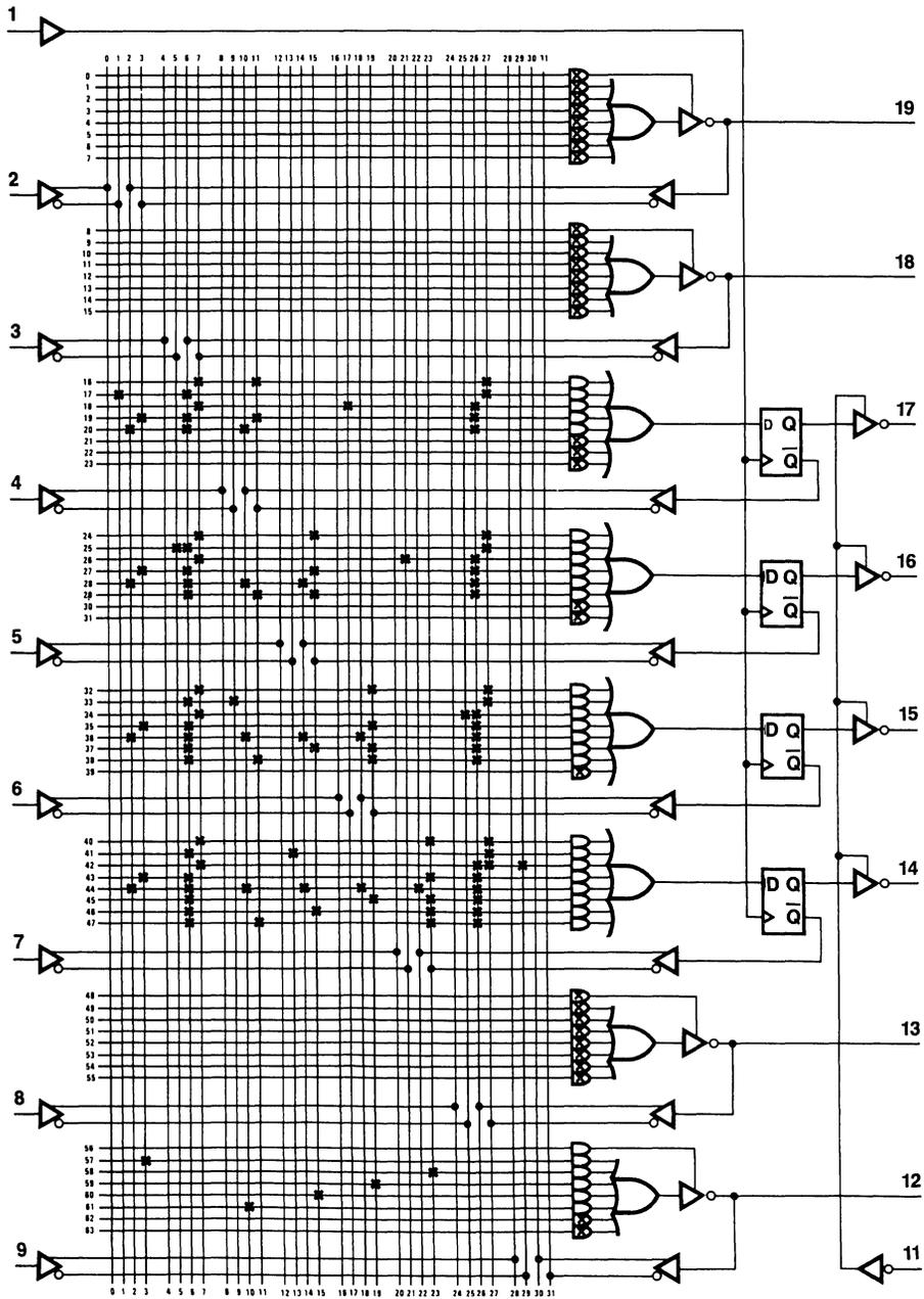
Figure 8.7.2 Logic Diagram PAL16R4
