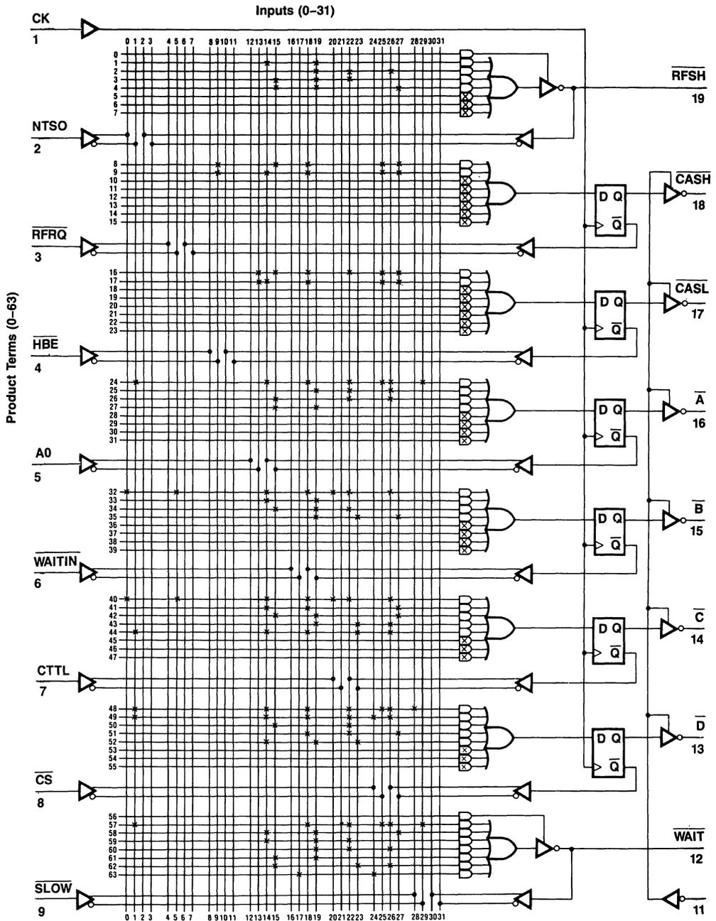
Figure 8.11.6 DP84312 Logic Diagram PAL16R6
