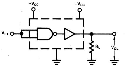
FIGURE 1. V<sub>IH</sub>, V<sub>OL</sub>
