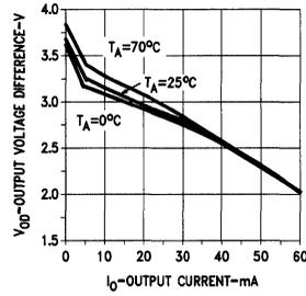
**Driver V<sub>OD</sub> vs I<sub>O</sub> vs V<sub>CC</sub>**
