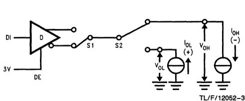
FIGURE 3. Driver V<sub>OH</sub> and V<sub>OL</sub>
