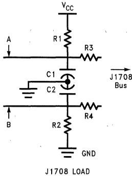
**FIGURE 3. Node Load Circuit**
