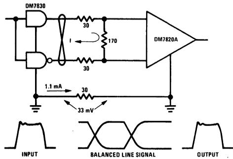
THE GROUND LOOP CURRENT IS MUCH LESS THAN SIGNAL CURRENT
