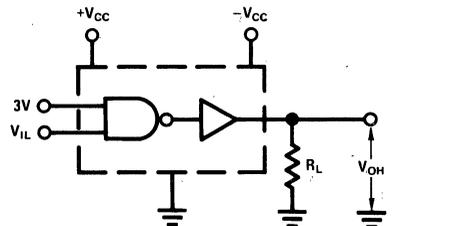
FIGURE 2. V<sub>IL</sub>, V<sub>OH</sub>
