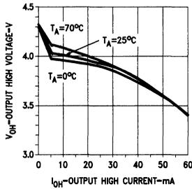
**Driver V<sub>OH</sub> vs I<sub>OH</sub> vs V<sub>CC</sub>**
