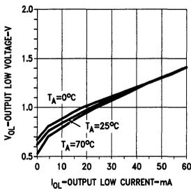
**Driver V<sub>OL</sub> vs I<sub>OL</sub> vs V<sub>CC</sub>**
