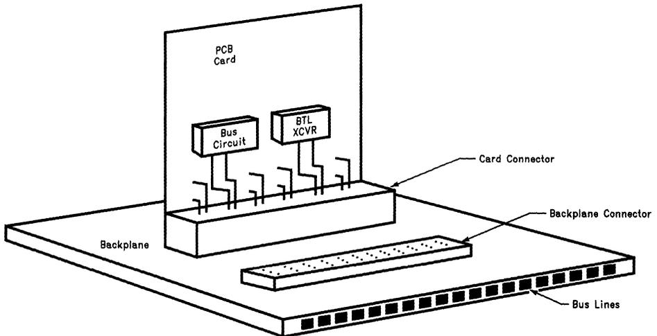
FIGURE 2. PCB-Backplane Interface
