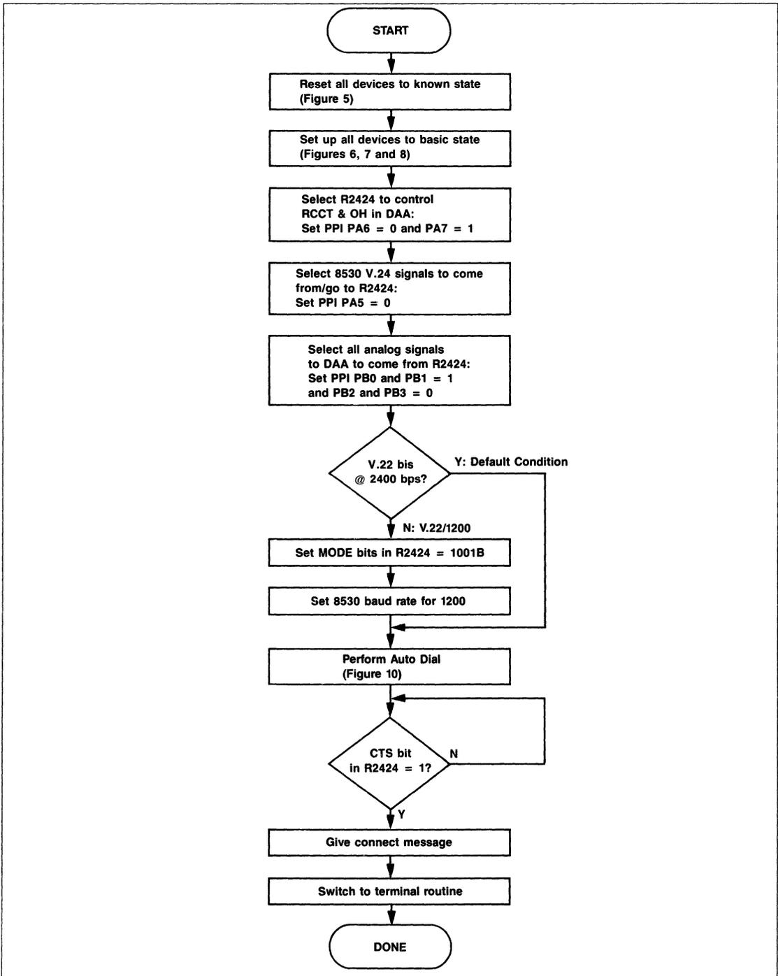
Figure 11. Flowchart — V.22 or V.22 bis Call Origination
