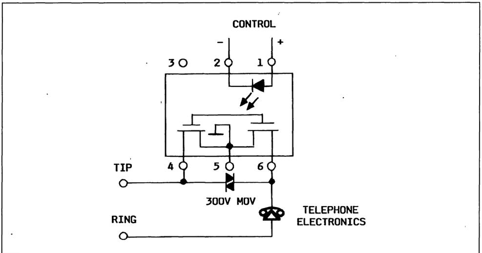
**DOUBLE POLE HIGH-VOLTAGE SOLID-STATE RELAY**
