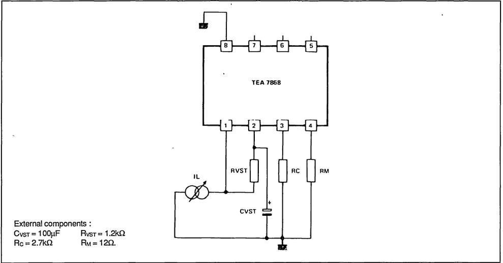
Figure 2 : Impedance Measurement.
