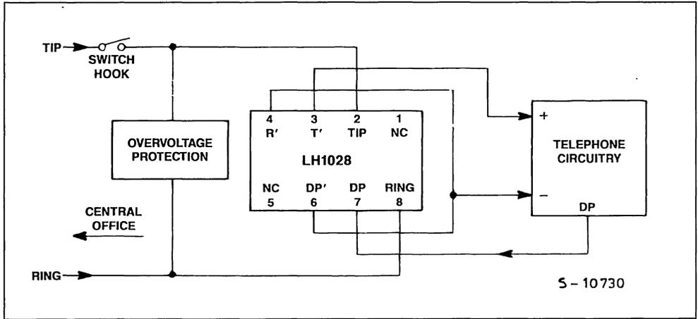
**SINGLE POLE HIGH-VOLTAGE SOLID-STATE RELAY**
