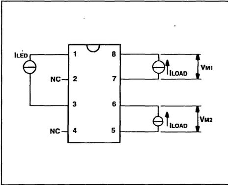
Figure 3 : Leakage Current.
