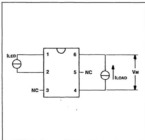
**Figure 3 : Leakage Current.**
