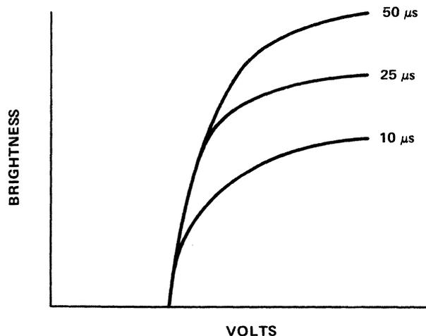
**(c) BRIGHTNESS DEPENDENCE ON PULSE WIDTH**
