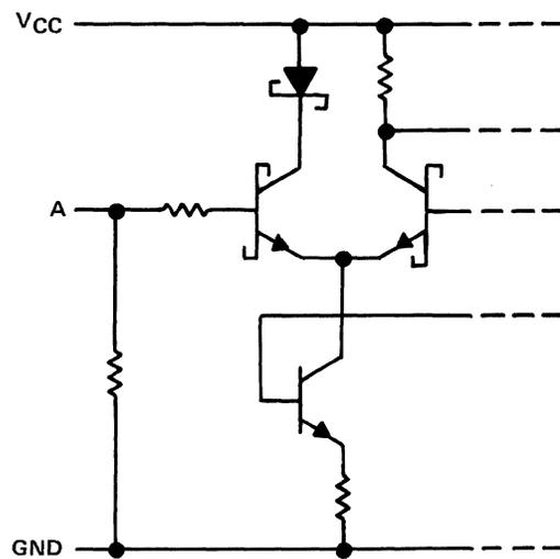
(d) EQUIVALENT OF EACH RECEIVER INPUT
