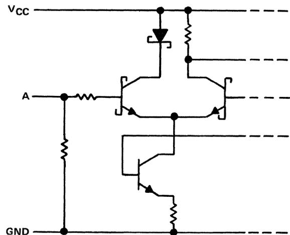
(d) EQUIVALENT OF EACH RECEIVER INPUT
