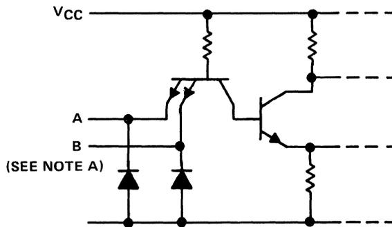
(d) EQUIVALENT OF EACH RECEIVER INPUT
