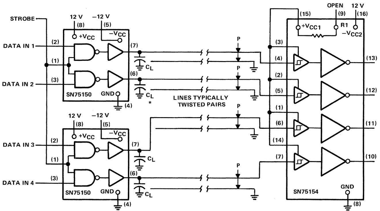
\* $C_L$  IS ONLY REQUIRED IF LINE CAPACITANCE IS INSUFFICIENT FOR PROPER WAVE SHAPING.
