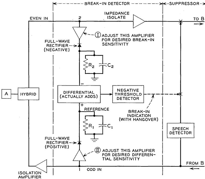
$R_1 C_1$  ADJUSTED TO DECAY TO HALF-VALUE IN ABOUT 20 MS (MORE PRECISELY,  $R_1 C_1 > 28.9$  MS; I.E. HALF-VALUE DECAY TIME IS AT LEAST 22.5 MS)
